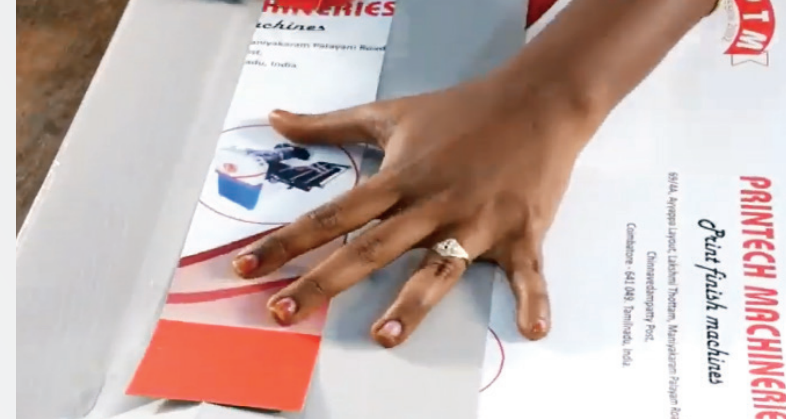
تركيب قاعدة الكيس الورقي باستخدام اللاصق
