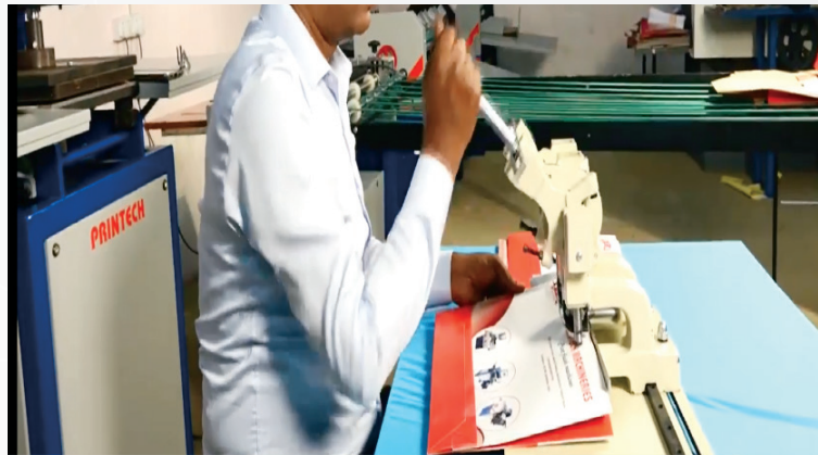
تركيب برشام للكيس الورقي باستخدام المكبس
